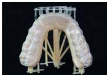
Schienen-Modellkombination aus dem 3D-Drucker
