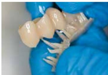
Einfaches Entfernen der Supportstrukturen
